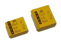
Полярные чип-конструкции постоянной емкости. Предназначены для работы в цепях постоянного и пульсирующего токов и в импульсном режиме. Конденсаторы разрабатываются в виде прямоугольной конструкции для внутреннего монтажа с двумя выводами в виде контактных площадок.
