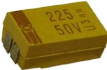
Конденсаторы в пластмассовом корпусе, опрессованного исполнения. Данные конденсаторы изготавливают в двух исполнениях: стандартном и низкопрофильном. Высота корпуса низкопрофильного исполнения не превышает 2.2мм.
