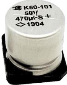
Полярные, постоянной ёмкости, чип-исполнения для работы в цепях постоянного и пульсирующего тока РЭА. Предназначены для внутреннего монтажа с требованиями стойкости к повышенной влажности воздуха 98% при температуре 35°C. Уплотненные. В неизолированном корпусе, закрепленном на пластиковой диэлектрической платформе.
