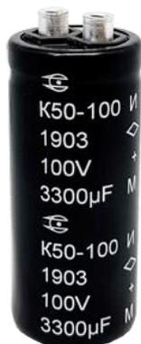
Полярные, постоянной ёмкости. Предназначены для внутреннего монтажа с требованиями стойкости к повышенной влажности воздуха 98% при температуре 25°C и 35°C, для работы в цепях постоянного и пульсирующего тока РЭА. Уплотнённые. В изолированном корпусе, с торцевой шпилькой и без неё, с радиальными выводами под винт.
