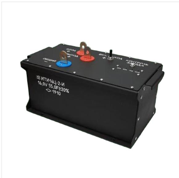
Крупногабаритные источники тока в металлическом прямоугольном корпусе, оснащенные системой контроля остатка заряда и встроенными DC/DC на входе или выходе, выполненные на основе мощностных конденсаторов с номинальным напряжением 2,7 В, защищенных от перенапряжения электронными схемами активной балансировки.
